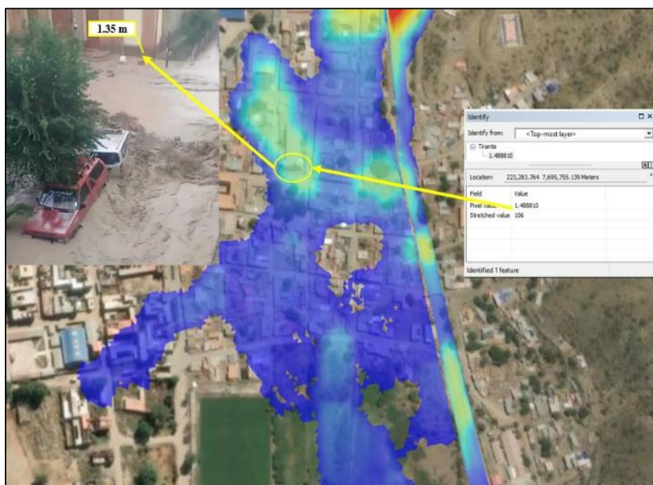
Figura 16. Validación de modelo hidráulico con huellas de agua
