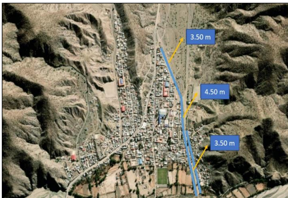
Figura 18. Ubicación de medidas estructurales para el proyecto
