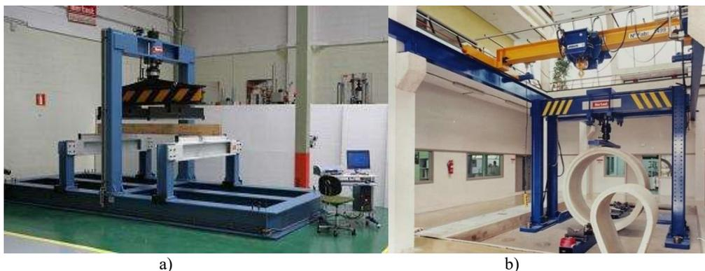
**Figura 1:** Tipos de pórtico de ensayo de materiales. a) Pórtico autoportante. b) Pórtico anclado [19].
