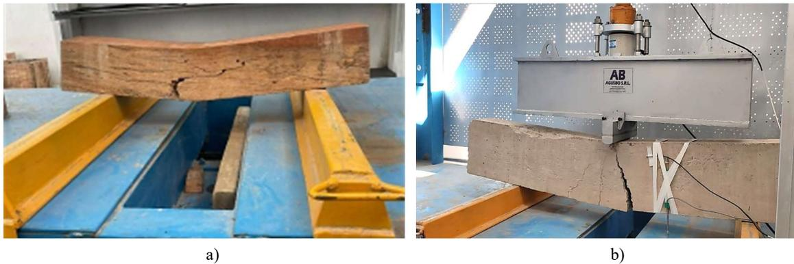
**Figura 9:** a) Viga de madera sometida a ensayo con falla estructural. b) Viga de hormigón armado tras prueba de flexión.
