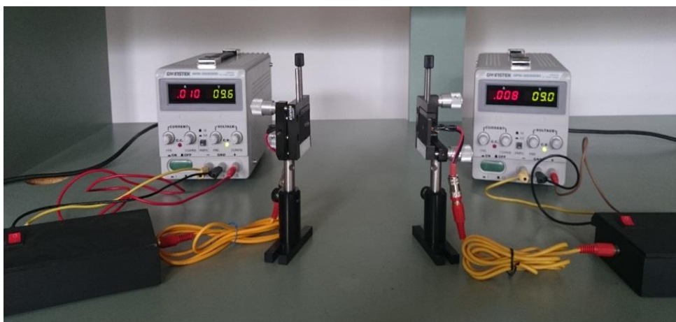
Figura 9 – Diseño final del sistema de transmisión inalámbrica de Video por luz visible.
