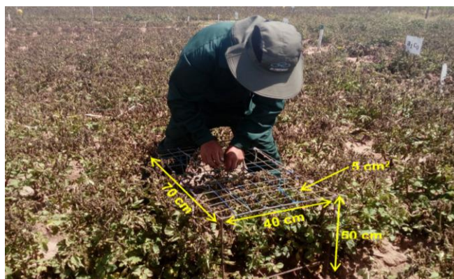
Figura 1. Vista del bastidor para la medición de la cobertura foliar.
