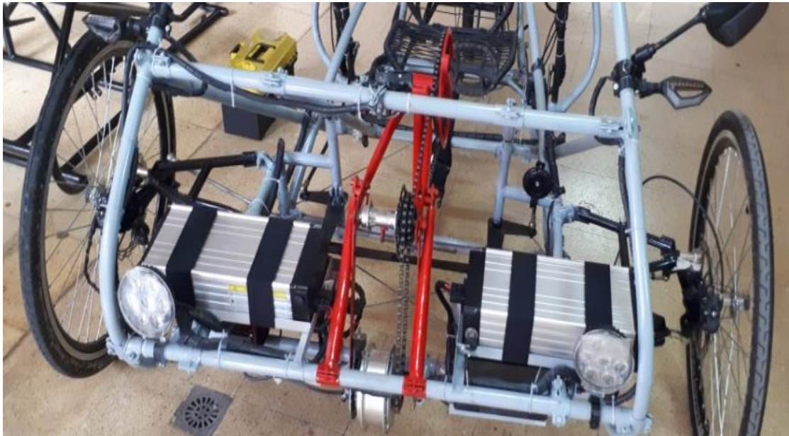
Figura 4. Baterías principales de ion de litio.
