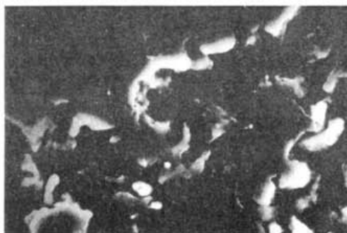
Fig 8. Fotografía al microscopio electrónico del carbón activado Norit.
