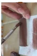
Aplicar engobe a la placa cerámica en estado cuero
