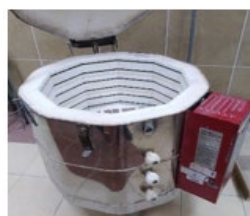
Someter a tratamiento térmico a 950°C
