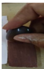
Bruñir engobe – placa cerámica
