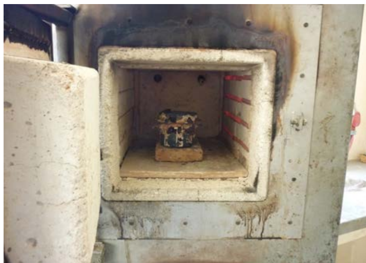
Figura 4. Horno para el tratamiento termoquímico de nitruración
