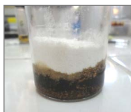
Figura 4. Fenómeno de capilaridad en la adsorción de aceite lubricante sobre ulexita
