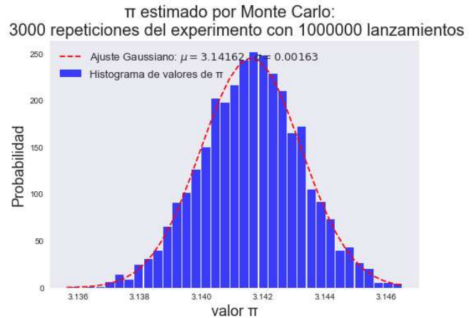
FIG. 6.— Histograma del método simple para 3000 repeticiones de 100000 lanzamientos. Se aprecia el comportamiento gaussiano, la característica forma de "campana".
