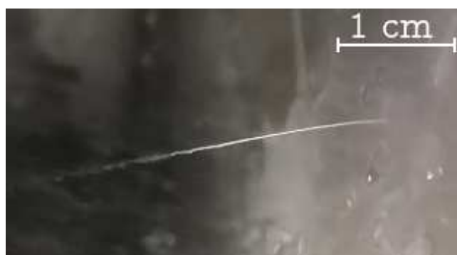
FIG. 4.— Se observa una trayectoria recta y delgada, este tipo de estela es producida por electrones e^- ó positrones e^+ muy energéticos.
