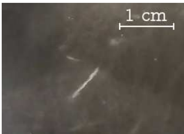
FIG. 3.— Trazas cortas y gruesas dejadas por una partícula \alpha , ya que interactúa con facilidad en el medio.
