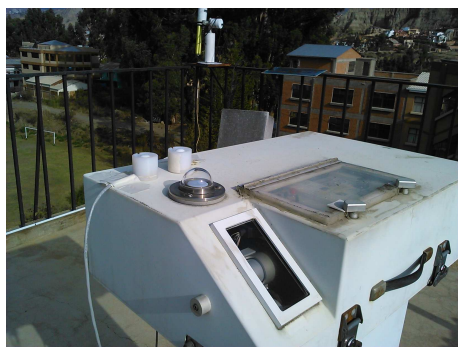
FIG. 1.— Sensores y domo del Brewer en Cota Cota (La Paz) 3430 msnm.
