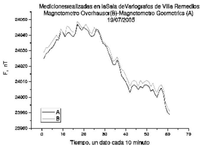
Figura 2. Registros de F de los magnetómetros Geometrics y Overhauser en un mismo punto, Villa Remedios.
