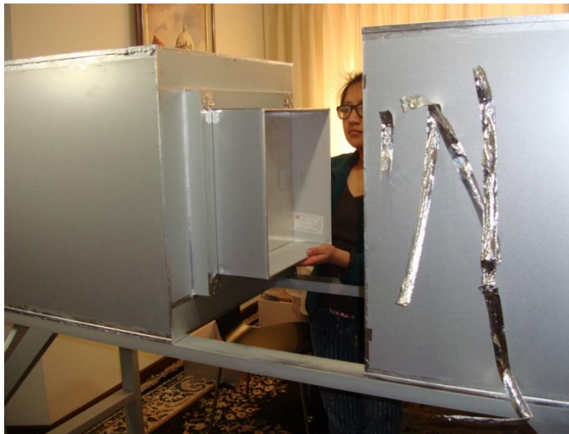
Figura 2: Vista externa de la cámara anecoica abierta.
