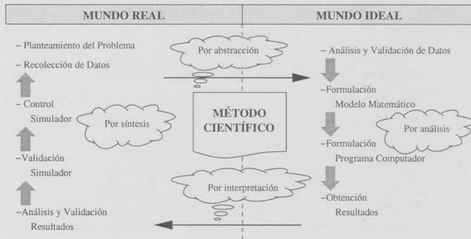
Figura 2: Metodología de la Simulación — pasos en el mundo real e ideal. Elaboración propia en base a [5].
