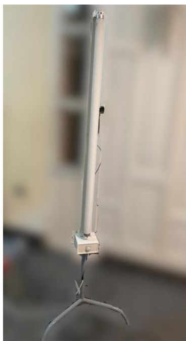
Figura 6: Estructura metálica regulable en altura + caja PVC.
