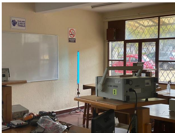
Figura 13: Módulo de desinfección en funcionamiento
