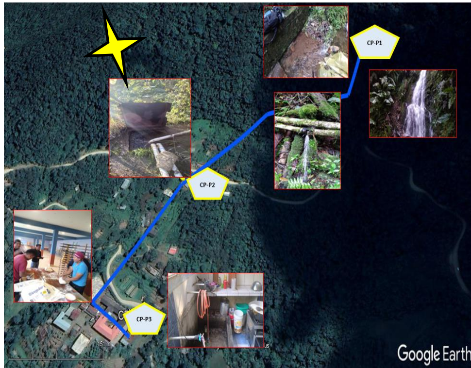
Figura 5: Esquema de abastecimiento de agua para la comunidad de Carmen Pampa. Fuente: Elaboración en base a Google Earth.
