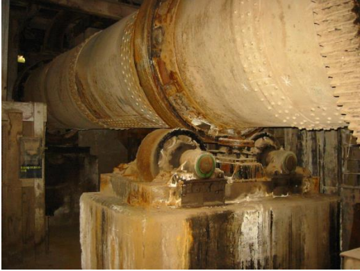
Hornos para cianuro en la mina El Brocal (Huancavelica, Perú)
