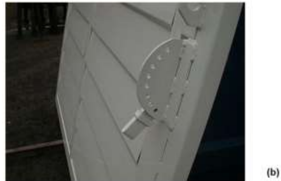
Figura 8. Reguladores de ventilación: (a) Puerta deslizable en un marco lubricado y (b) Cortina persiana de ocho posiciones.
