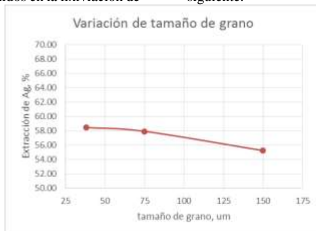
Figura 10. Efecto del tamaño de grano en la extracción de Ag en la muestra 4 (PC8 a PC10).
