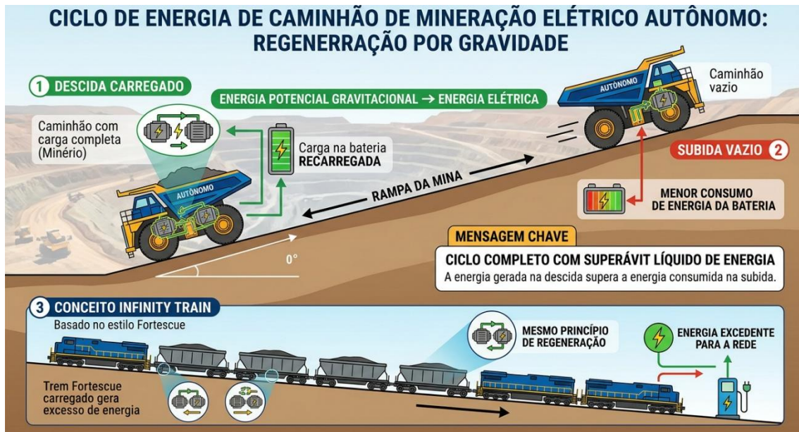
Figura 3. - Princípio da regeneração gravitacional
