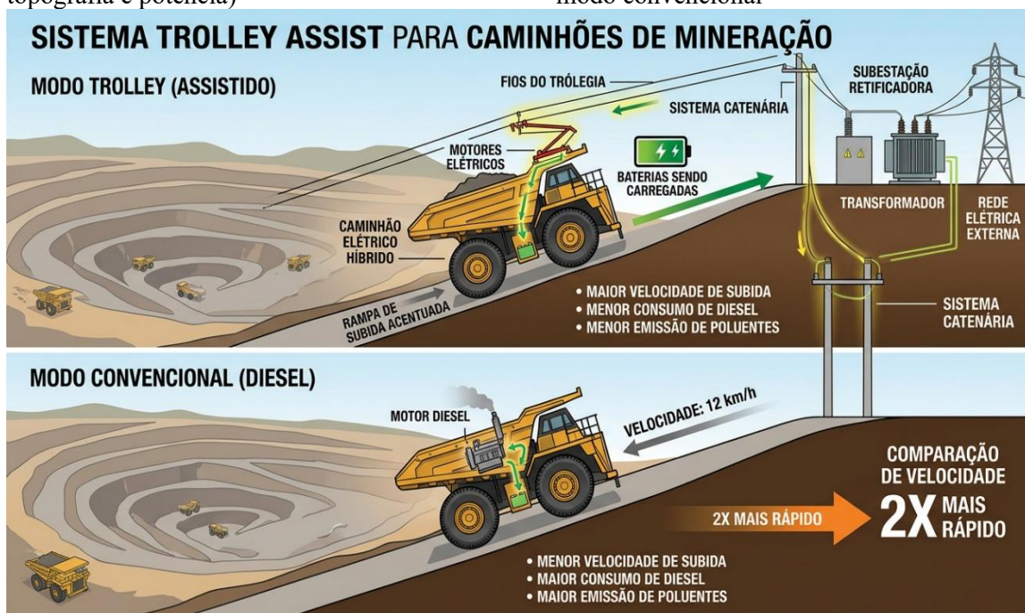
Figura 2. - Comparativo entre o sistema Trolley Assistido para caminhões e o modo convencional
