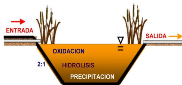
Figura 3. Principales procesos en un humedal aerobio.
