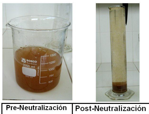
Foto 2. Resultados del tratamiento de aguas ácidas de mina en ensayos experimentales.
