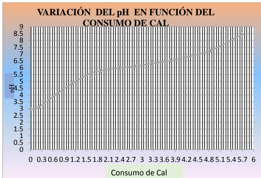
FIGURA 1: Curva de neutralización-precipitación (consumo de cal vs pH) de las aguas ácidas de mina
