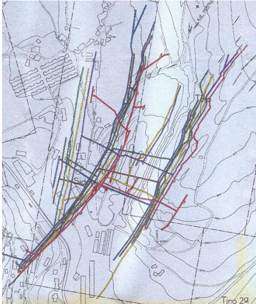
Figura 2. Plano de labores subterráneas de Fontao
