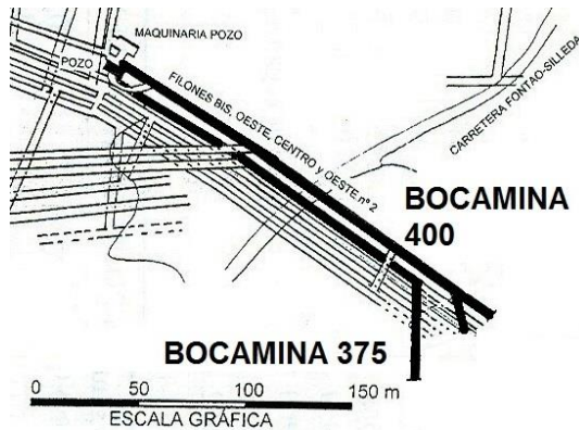
Figura 24. Galerías rehabilitadas (en negro)
