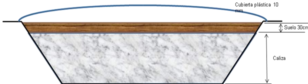
Fig. 5. Esquema de un drenaje anóxico sobre caliza
