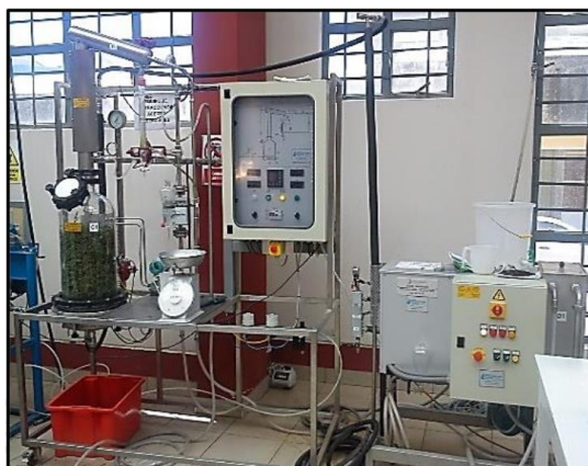
Figura 1 Proceso de destilación por arrastre con inyección de vapor
