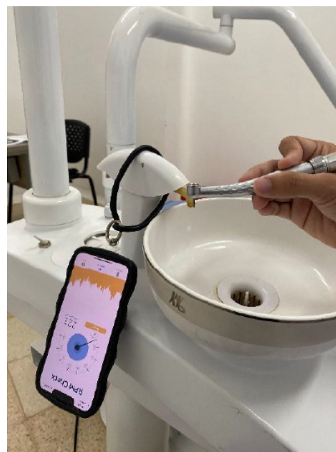
Figura 3. Esquema de medición del rpm de las piezas de alta velocidad. Fuente: elaboración propia.
