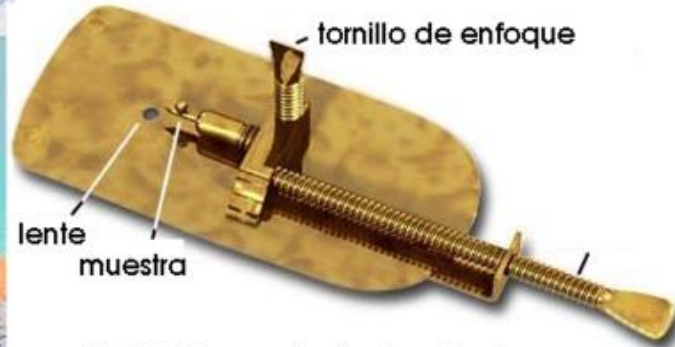
Fig 11: Microscopio simple realizado por Antoni van Leeuwenhoek, hacia 1668. en Leyden, HOLANDA.
